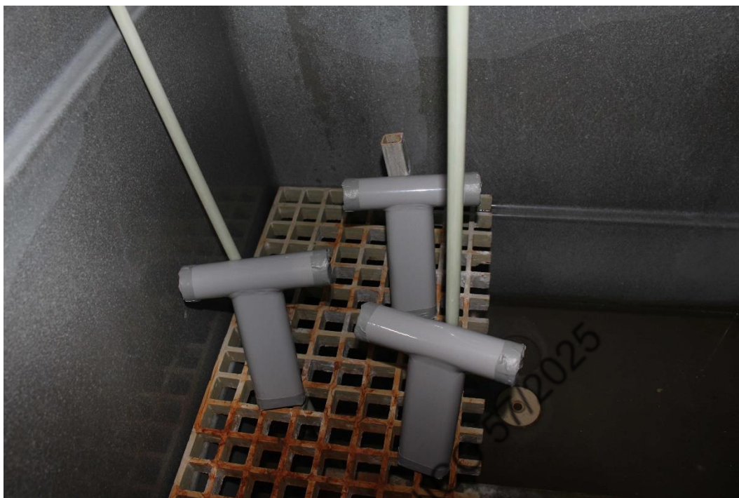
Disposição da amostra na câmara de ensaio.
