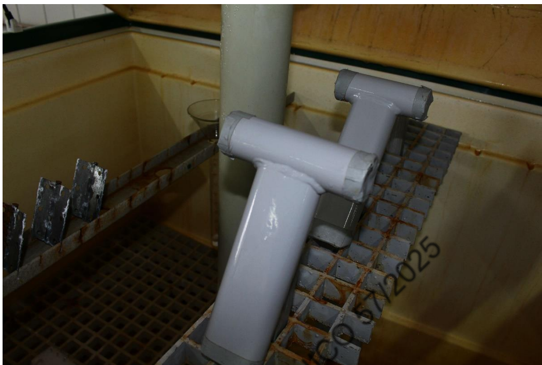
Disposição da amostra na câmara de ensaio.
